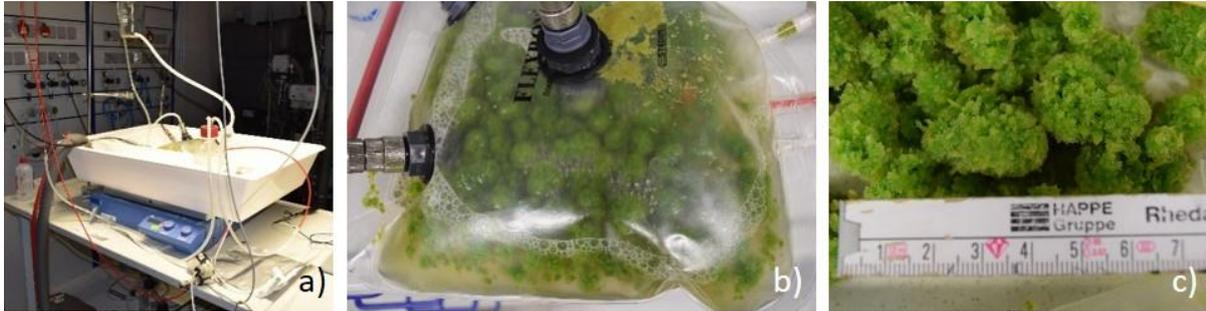
**Abb. 16.** Kultivierung von *S. palustre* in einem 5 L *Wave bag*-Photobioreaktor. a) Aufbau eines 5 L *Wave bag*-Photobioreaktors, b) *S. palustre* im Photobioreaktor am Ende der Kultivierung (Tag 30) sowie c) im Detail nach der Ernte (Fotos: Ingrida Melkova).
