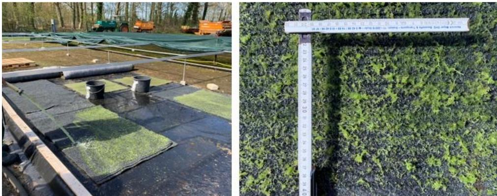
**Abb. 22.** Nassansaat mit 1 L *S. palustre*, + 30 L Wasser + 15 mL Kleber (Terra-Control®) (Fotos: Hendrikje Schreiter).
