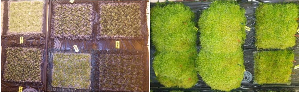
**Abb. 23.** Versuch zu Fixierung und Ausbringdichte von nichtausdifferenziertem *S. palustre* Klon 12a (aus Submerskultur) an der Torfmooswand, links) zu Versuchsbeginn, rechts) nach sechs Versuchsmonaten (Fotos: Anja Prager).
