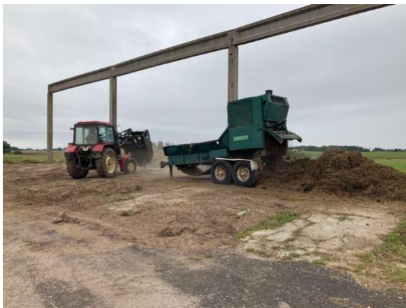
1 pav. Žolės smulkintuvas komposto gamybai. Traktoriumi atgabenamas žolės rulonas.
