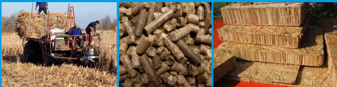
Po lewej: zbiór pałki ( Typha spp. ) w Kamp, Niemcy (fot. W. Wichtmann). Zdjęcie środkowe i po prawej: pellet energetyczny i płyty wielowarstwowe wykonane z trzciny i pałki (źródło: www.wetland-products.com )
