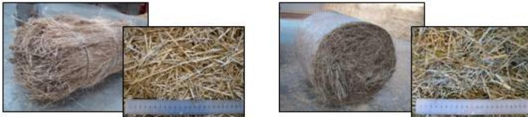
Abbildung 3.3-9: Brennstoffproben: Schilf und Rohrglanzgras (Großballen + Häcksel)
