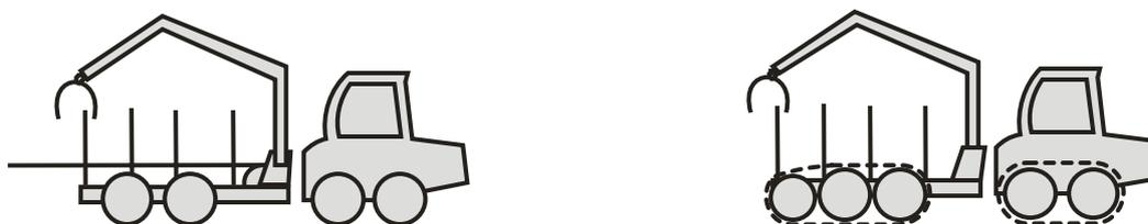
**Abbildung 3.6-6: Tragschlepper aus dem Forstsektor (8 bzw. 10 Räder, mit bzw. ohne Bänder)**
