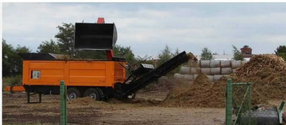
Abbildung 3.4-7: Brennstoffaufbereitung mittels werksinternem Brecher für die Testverbrennung
