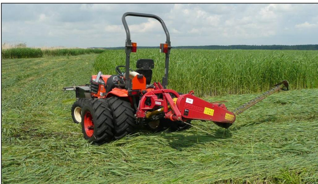
**Abbildung 3.1-6: Modifizierter Kleintraktor mit Balkenmäher zur Sommermahd von Röhrichten im Rahmen von Naturschutzmaßnahmen**
