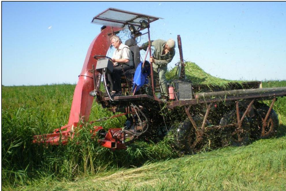
**Abbildung 3.1-4: Modifizierte Saiga-Schilferntemaschine mit Frontanbau eines Feldhäckslers zur Sommermahd von Röhrichten im Rahmen von Agrarumweltprogrammen**
