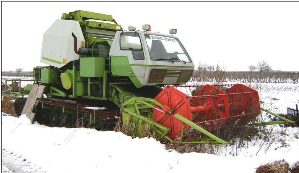
**Abbildung 3.1-3: Modifizierte Pistenraupe: Mähdrescherschneidwerk und aufgesetzte Ballenpresse**
