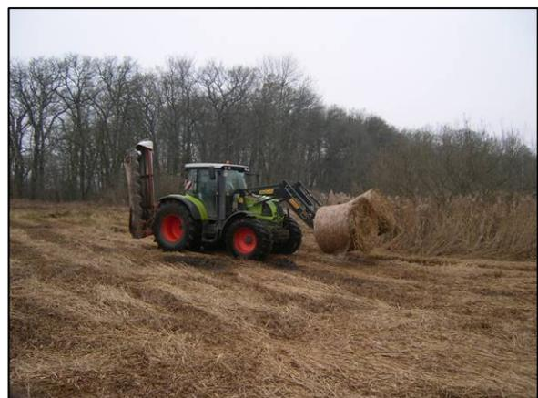
**Abbildung 3.6-4: Probeernte von Schilf mit Mähwerk und Ballenpresse (14.01.2009)**
