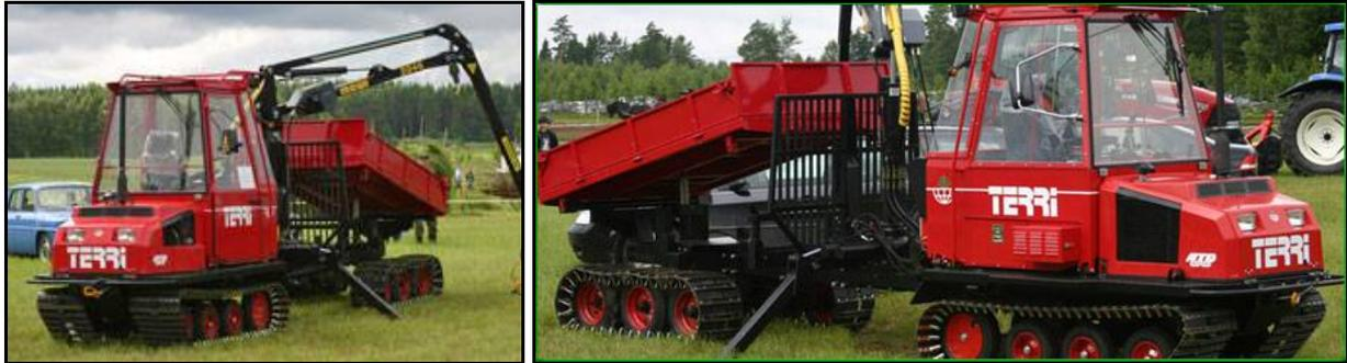
**Abbildung 3.6-7: Leichter Tragschlepper „Terri ATD“**
