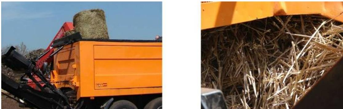
**Abbildung 3.4-6: Beschickung und Verstopfung des Brechers beim Brechversuch**
