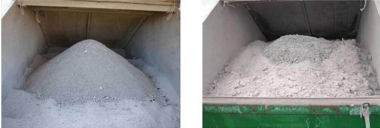
**Abbildung 3.4-9: links: Asche der RGG-Verbrennung, rechts: Asche der Holzverbrennung**
