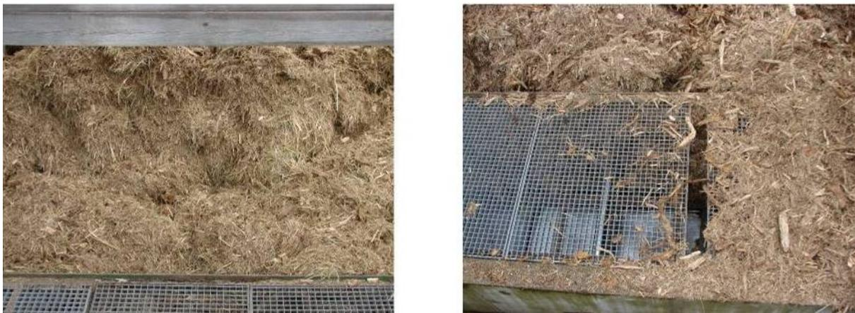
**Abbildung 3.4-8: Verfilzung des Brennmaterials bedingt durch RGG**
