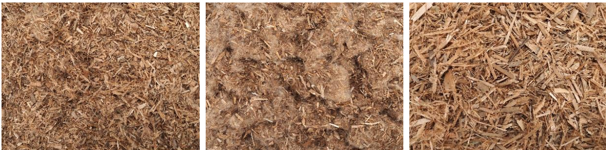
Abbildung 1: Unterschiedliche Einblasdämmungen aus Rohrkolben ( Typha latifolia ). Links: Material mit max. 20 % Kolben im geernteten Bestand, Mitte: Material mit ca. 90 % Kolben im geernteten Bestand, Rechts: Material aus unbekannter Herkunft. (Fotos: Pilz/Nordmeyer, LWK Niedersachsen)
