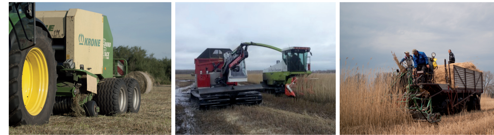
Abb. 5-7: Rundballenpresse mit Tandemachse, raupenbasierte Spezialtechnik, Dachschilfernte (v.l., T. Dahms, J. Jorritsma, T. Dahms)
