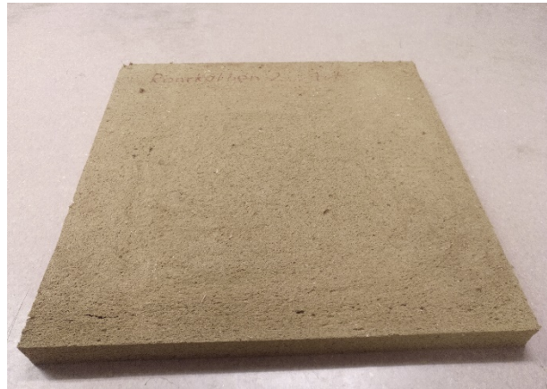
Abbildung 15: Aus Typha angustifolia hergestellter Prototyp der Schaumplatte 50 x 50 cm
