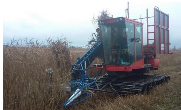
Abb. 1: Mahd eines Schilfröhrichts mit raupenbasierter Technik (Foto: F. Birr, 12/2018)
