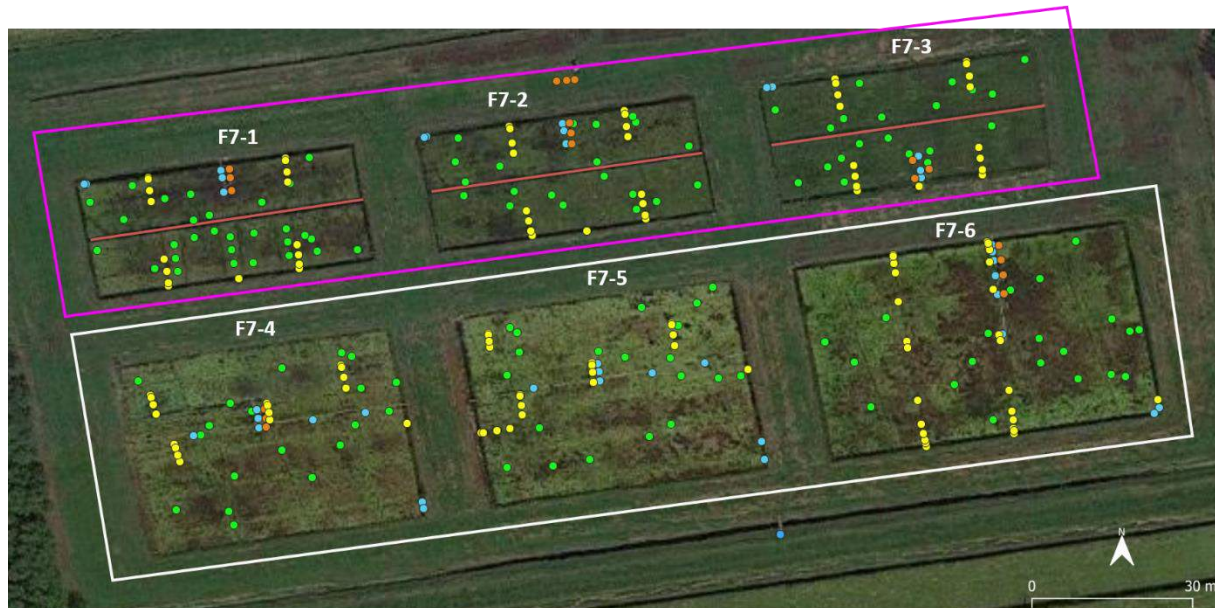
Abbildung 7. Detaillierte Lage der Flächen für die Versuche ‚Minimierung Oberbodenabtrag‘ (F7-1 bis -3, pink umrandet) und ‚Minimierung Grabenanteil‘ (F7-4 bis -6, weiß umrandet) (Varianten siehe Tabelle 1) mit Untersuchungen zu Vegetationsentwicklung/ Biomasse (grüner Punkt), Wasserstand (Pegel, blauer Punkt), Nährstoffen (gelber Punkt), Treibhausgasen (oranger Punkt), Libellen (rosa Linie). Legende siehe Abbildung 5, Lage in der gesamten Feldversuchsfläche zur Torfmoos-Paludikultur im Hankhauser Moor siehe Abbildung 4. Kartenquelle Google Satellite (2023) in QGIS.
