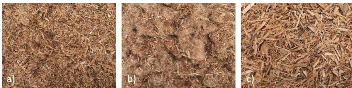
Abbildung 18. Einblasdämmungen aus Rohrkolben ( Typha latifolia ): a) Material mit max. 20 % Kolben im geernteten Bestand, b) Material mit ca. 90 % Kolben im geernteten Bestand, c) Material aus unbekannter Herkunft. (Fotos: Pilz/Nordmeyer, LWK Niedersachsen)
