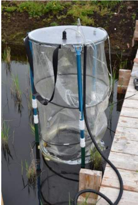
Abbildung 14. Messung des Treibhausgasaustausches mit transparenter Haube im Filterbecken FB2 im Mai 2021. (Foto: C. Daun)
