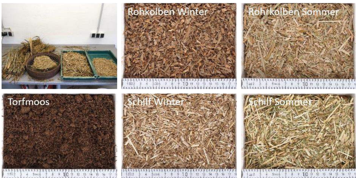
Abbildung 20. Aufbereitung der Rohstoffe und die gebrauchsfertigen Substratausgangsstoffe. (Fotos: Pilz/ Nordmeyer, LWK Niedersachsen)
