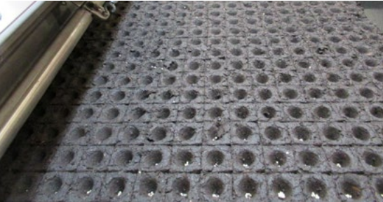
Abb. 20 Probepressung auf der Unger Erdpresstopfmaschine
