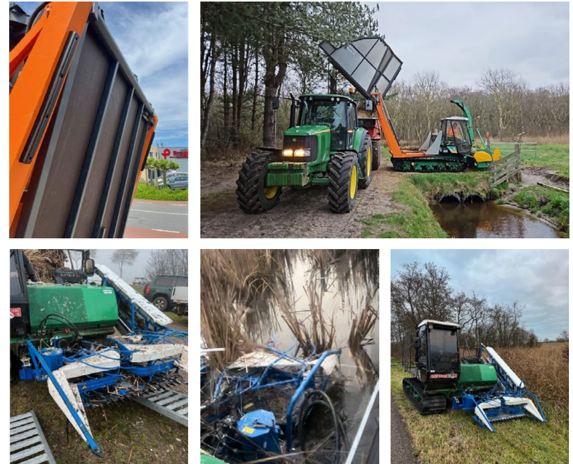
Abb. 26 Hochkipper l. und r. (o. l.), Einsatz in Nordholland (o. r.), BCS Ernte mit Rohrkolben-Umbau (unten l. m. r.)
