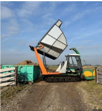
Abb. 33 Hochkipper mit 11 m 3 kippt Erntematerial ab
