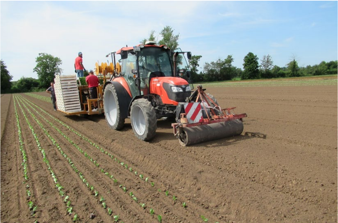
Abb. 22 Die Bänderpflanzmaschine im Einsatz
